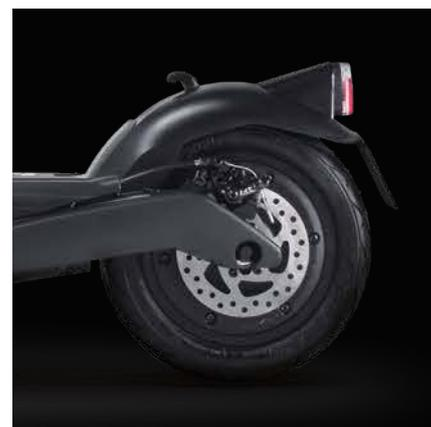
Freins à disque avant et arrière, avec KERS
